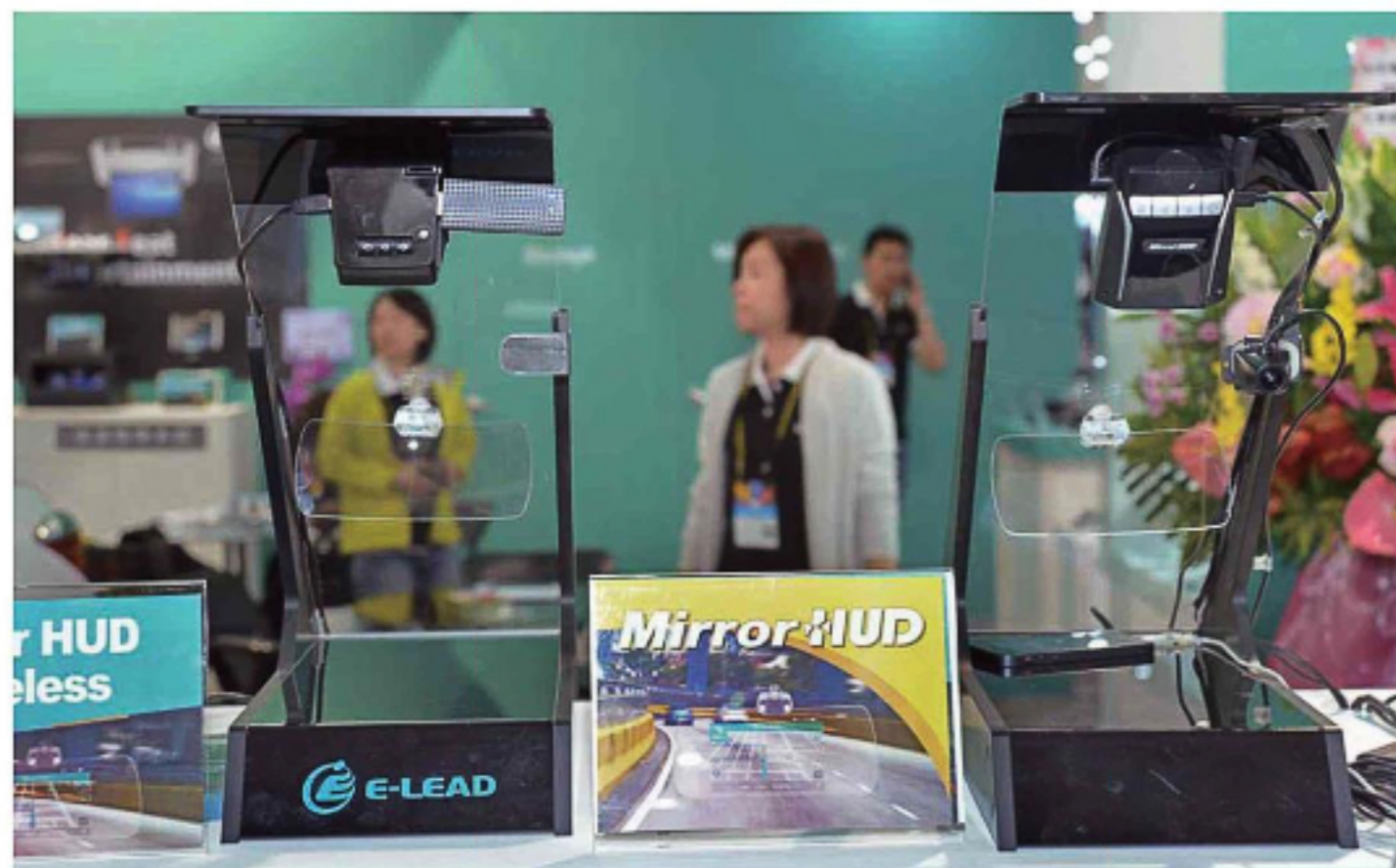
怡利電子的「遠距成像抬頭顯示器」可投射出懸浮影像資訊在前方道路上，降低視線轉移的視差，提升駕駛者行駛中的安全性。
