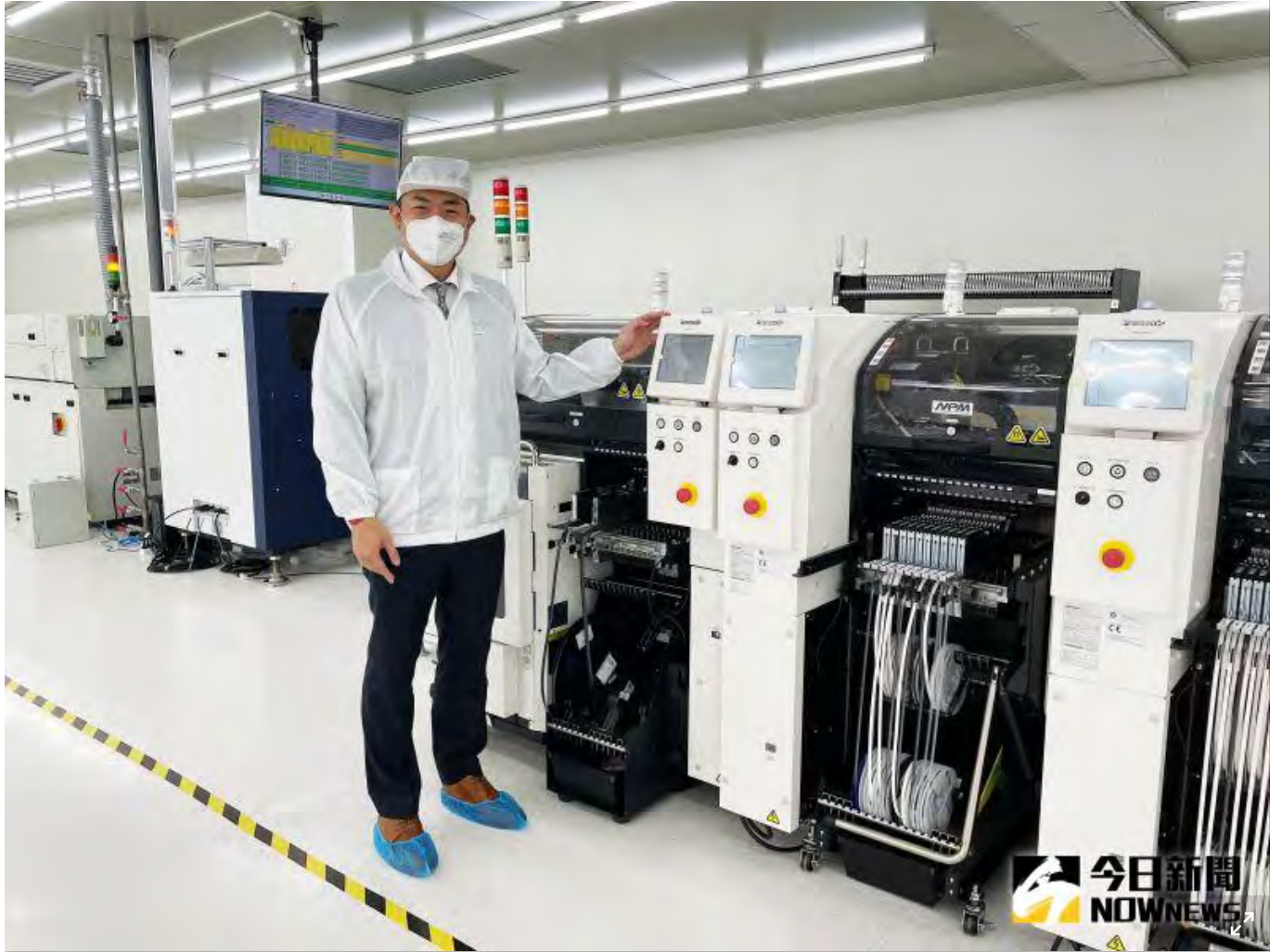
▲林傳凱表示，凱銳高雄廠的設立在硬體部分將採用最新的研發設備，所有生產線上的產品都採用最嚴格的標準。圖為松下高速置件機可以針對高速運算產品做最有效率的搭配。(圖 / 記者郭俊暉攝)
