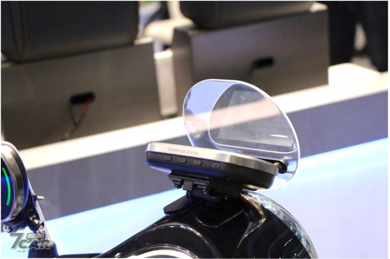
MPD 機車專用抬頭顯示器模組安裝於龍頭中央。
