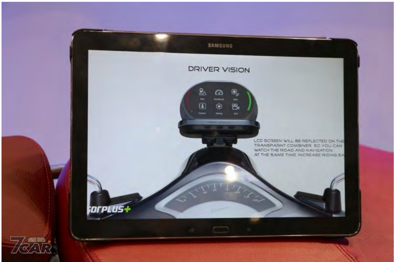
透過 4.3 吋解析度 480x272 的 LCD 螢幕，向上方的反光片投影，可顯示盲點偵測系統資訊、行車記錄器影像及其他車用功能。
