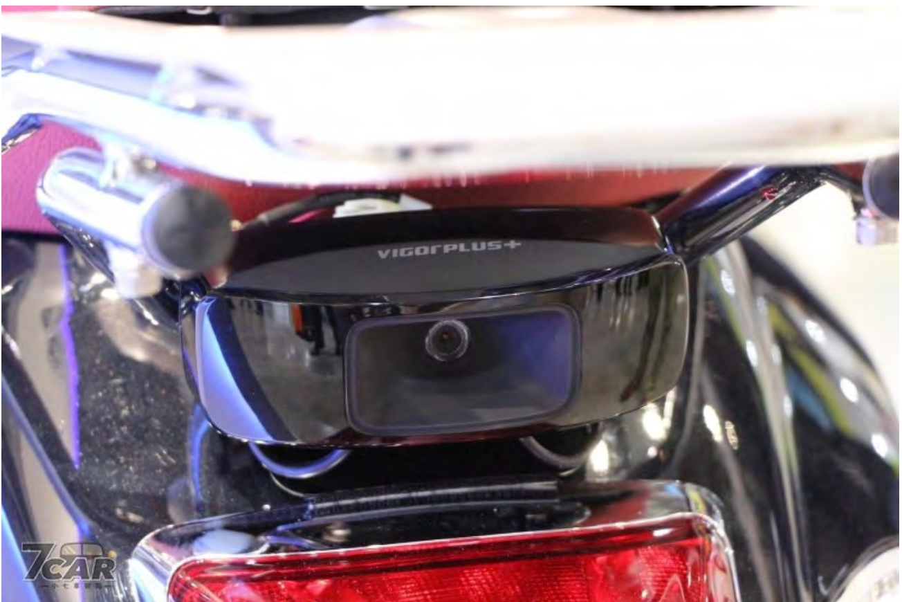
BSM 盲點偵測模組安裝於車尾燈上方。具備 IPX6 防水等級，可抵抗高壓噴水槍水柱達 3 分鐘。
